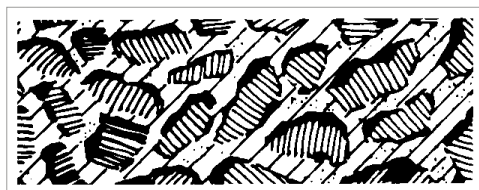
OTEVŘENÁ STRUKTURA OBSAHUJE AŽI O 1/3 MÉNĚ BRUSNÉHO ZRNA NEŽ UZAVŘENÁ
