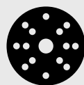
ø150mm s 15-ti dírami ø9mm na kružnici ø120mm; 6 děr ø9mm na kružnici ø80mm + 1 středová díra ø17mm
